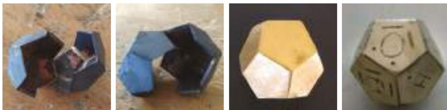
Figure 19 - Différentes étapes de la réalisation du dé gravé en métal.
