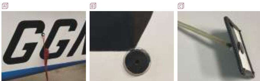
**Figure 10** - Prise de pression statique sur un avion-école de type TB10. **(A)** **(B)** On observe la prise de pression fixée sur le fuselage de l'avion - **(C)** On observe la connexion entre ce capteur et l'anémomètre à l'aide d'un tuyau souple.
