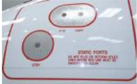
**Figure 11** - Exemples de prises de pression statique sur un avion de ligne ; le capitaine et le copilote ont des instruments de bord séparés qui utilisent des prises de pression statique indépendantes (F/O et CAPT) pour doubler les informations, assurer un maximum de sécurité. Il y a même une troisième prise de secours (STBY) indépendante des deux autres pour prévenir la défaillance d'un des systèmes si l'indication de l'une des sondes n'est plus concordante avec les deux autres.
