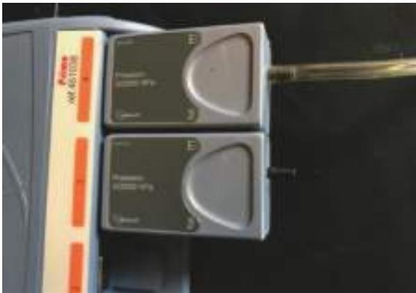
**Figure 27** - Deux capteurs à prise de pression simple.
