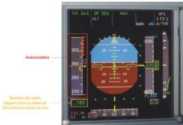
Figure 2 - PFD (*Primary Flight Display*) d'un avion de ligne (Airbus A320). On aperçoit à gauche sur le PFD, la partie anémomètre avec une vitesse indiquée égale à environ 285 kt (ou nœud) et en dessous de l'anémomètre, l'indication du nombre de Mach (ici 0,780).
