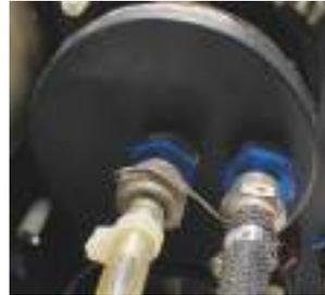
**Figure 8** - Anémomètres vus de l'arrière. [A] On observe les deux orifices d'entrée - [B] On observe la connexion de ces orifices aux capteurs par deux tuyaux souples.
