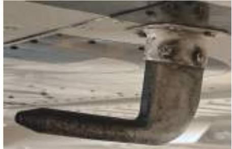
**Figure 12** - Tube de Pitot. On aperçoit les deux électrodes reliées à un générateur qui permettent le réchauffement de la sonde en cas de risque de givrage.
