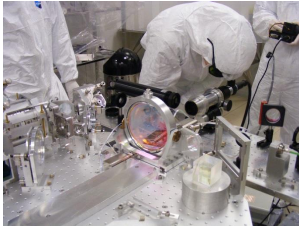
Alignement du télescope d'injection d'Advanced Virgo. © APC
