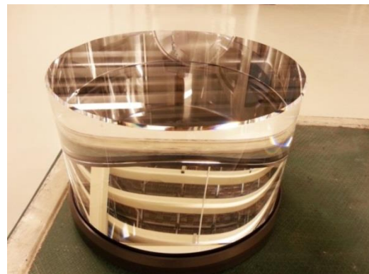
Un grand miroir de 40 kg pour Advanced Virgo (350 mm de diamètre, 200 mm d'épaisseur)
