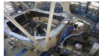
Instrument Sphère équipé du système d'Optique Adaptative sur le VLT
