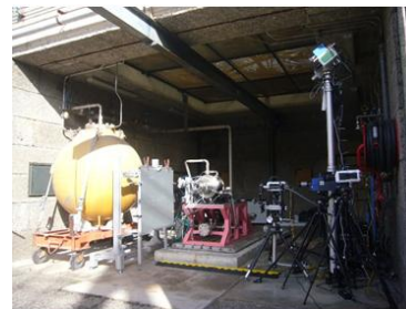
Mesure de signature sur un propulseur statique
