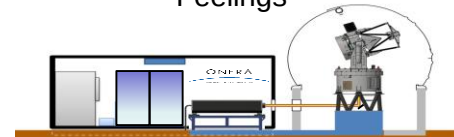
Instrument Sphère équipé du système d'Optique Adaptative sur le VLT
