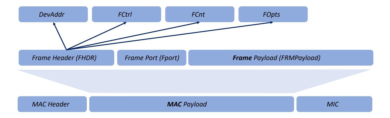
MAC Header (1-byte) | DevAddr (4-bytes) | FCtrl (1-byte) | FCnt (2-bytes) | FPort (1-byte) | FRMPayload (1-byte) | MIC (4-bytes) → 14 bytes
