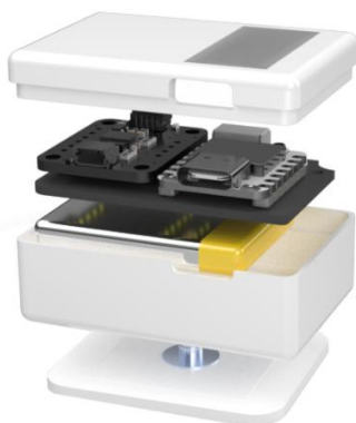
Le RECORD pod est un système de mesure sans fil utilisable n'importe où (évitant ainsi les contraintes liées à l'utilisation d'un laboratoire dédié à l'analyse de la marche) © USMB
